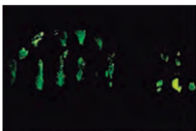
Huella de zapato tratada con amarillo ácido 7, fotografiada en una habitación oscurificada, iluminada con una fuente de luz de 455 nm y a través de un filtro naranja. (f/13 a 20 segundos, ISO 500 con una cámara SLR digital montada en un trípode)
